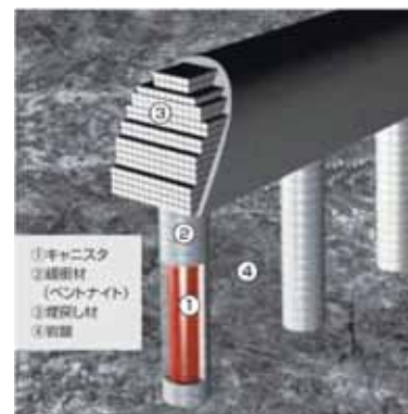
キャニスタの定置イメージ オンカロの坑道と試験処分孔
