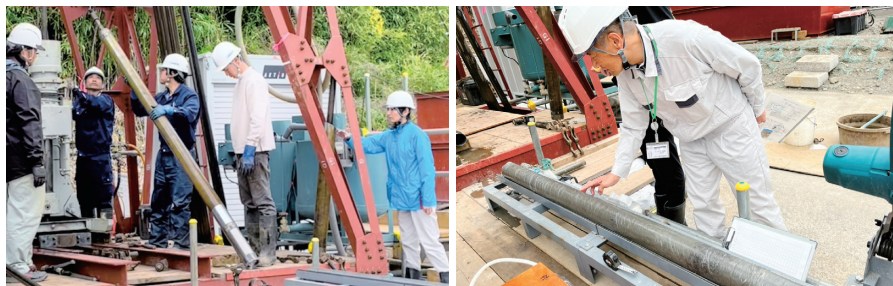
左:コア(岩石)の引き上げの様子を見守る技術部の若手職員(右)/右:採取したコアの状態を確認する技術部職員
