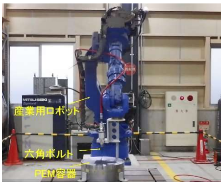
図 10 試験状況 (蓋結合試験)
