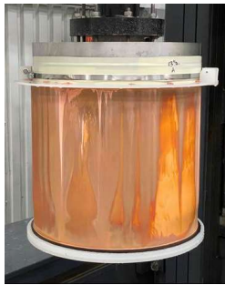
(a) 銅電気めっき試験体
