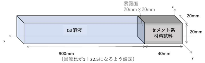
図 2 反応輸送解析モデルの解析体系
