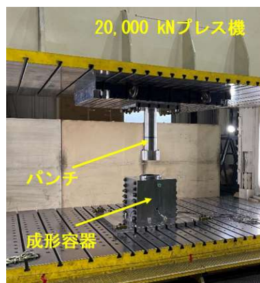
図 5 試験状況（容器 300.5 mm, 実規模の 1/8 スケール）
